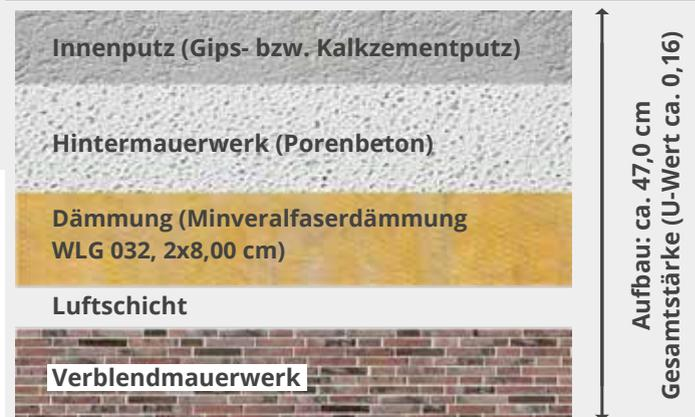
Für die Verblendsteine (7 - 11% Wasseraufnahme) haben wir einen Preis von 750,- € inkl. MwSt. pro 1.000 Stück im Normalformat (NF) kalkuliert. Andere Formate können gegen Mehrpreis verarbeitet werden. Die Verlegung erfolgt mit Mörtel in der Farbausführung: Zementgrau (Quick Mix, VK01) im eigenen Saft bzw. nachträglich verfugt – je nach Verblendstein (Klinker bzw. Wasserstrichziegel gegen Mehrpreis) und Wetterlage.
